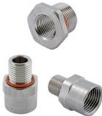
Les adaptateurs de la série ADAP offrent flexibilité et polyvalence en remplissant les entrées inutilisées des équipements Ex, tout en maintenant une protection antidéflagrante Ex d, une protection contre les explosions Ex e à sécurité accrue et un indice de protection IP66/67/68.
