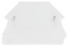
Abschlussplatten werden an der offenen Seite der letzten Reihenklemme vor dem Endwinkel befestigt. Mit dem Einsatz der Abschlussplatte wird die Funktion der Reihenklemme sowie die angegebenen Bemessungsspannung aufrechterhalten. Ein Berührungsschutz von Spannungsführenden Teilen wird gewährleistet, und die Abschlussklemme ist fingersicher.
