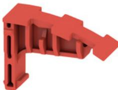
Die Schaltsperre kann von oben leicht in die Klemme eingelegt werden. Die Schaltsperre verhindert das ungewollte Öffnen oder Schließen von Stromkreisen. Sie blockieren den Trennhebel in seiner jeweiligen Stellung.
