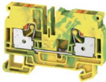
Через клеммный блок проходит проводник, который используется в различных целях, в том числе для обеспечения безопасности. Заземляющие клеммы предназначены для электрических и механических соединений между медными проводниками и монтажной опорной табличкой. На них приходится одна или несколько точек для соединений с PE проводами с или без бифуркации.
