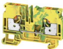
Un bloc de jonction de passage protecteur est un conducteur électrique de sécurité et est utilisé dans de nombreuses applications. Pour établir la connexion électrique et mécanique entre les conducteurs de cuivre et la plaque de support de montage, on utilise des blocs de jonction PE. Ils disposent d'un ou de plusieurs points de contact pour la connexion et/ou la dérivation de conducteurs de terre protecteurs.
