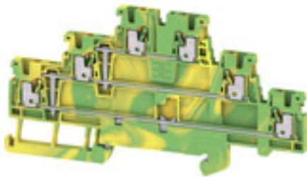
Eine schützende Durchgangsreihenklemme verbindet für Sicherheitszwecke eingesetzte elektrische Leiter und wird in vielen Anwendungen benötigt. Die elektrische und mechanische Verbindung zwischen Kupferleitern und der Befestigungsauflage wird mithilfe von Schutzleiterreihenklammern hergestellt. Sie verfügen über ein oder mehrere Klemmstellen für die Verbindung mit und/oder Abzweigung von Schutzleitern.
