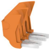
Die Kurzschlussbrücke wird einfach und schnell in die Reihenklemmen eingelegt. Werden mehrere Hebel gleichzeitig mit dem Hebelverbinder umgelegt, so wird der Zwangskurzschluss in der Applikation realisiert. Einmal montiert, lässt sich die Kurzschlussbrücke nicht mehr aus der Applikation demontieren.
