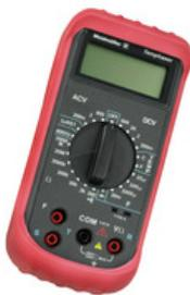
Les multimètres peuvent mesurer un grand nombre de grandeurs. De manière standard, tous les instruments peuvent mesurer la tension et la résistance et peuvent effectuer des tests de continuité et de diodes.
