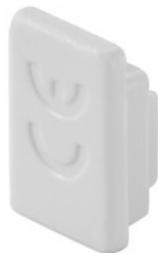
Колпачковые заглушки и крышки обеспечивают требуемое расстояние утечки в системе даже после раскроя шин под нужную длину или в случае свободностоящих контактов и гарантируют безопасность пальцев в соответствии с DIN EN 50274.
