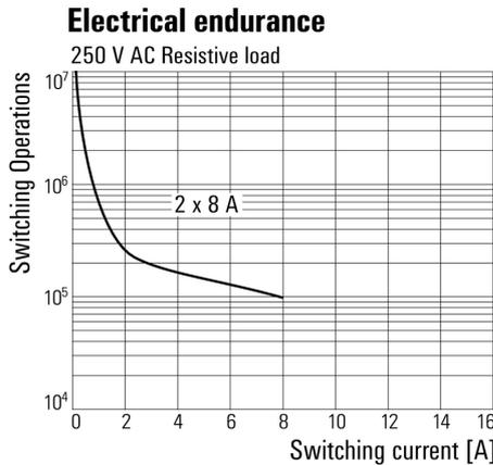
Elektrische Lebensdauer 230 V AC resistive load
