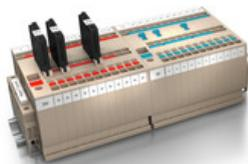
Das einzigartig modulare Konzept lässt sich auf jeden Maschinentyp anpassen. Die Potenzialverteilerreihenklammern AAP überzeugen durch einheitliches Design mit zwei möglichen Aufbauten – alternierend oder gruppiert. Bei dem gruppierten Aufbau der Steuerstromverteilung befinden sich die Potentiale auf unterschiedlichen Reihenklammern und bilden dadurch ganze Potentialblöcke.
