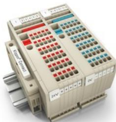
Das einzigartig modulare Konzept lässt sich auf jeden Maschinentyp anpassen. Die Potenzialverteilerreihenklempen AAP überzeugen durch einheitliches Design mit zwei möglichen Aufbauten – alternierend oder gruppiert. Bei dem gruppierten Aufbau der Steuerstromverteilung befinden sich die Potentiale auf unterschiedlichen Reihenklempen und bilden dadurch ganze Potentialblöcke.
