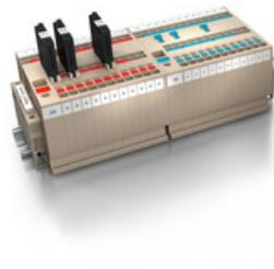
Le concept modulaire unique peut être adapté à chaque type de machine. Le succès des blocs de jonction de distribution de potentiel vient de leur design uniforme avec deux constructions possibles - en alternance ou groupée. Dans la structure groupée de la distribution du courant de commande, les potentiels sont situés sur différents blocs de jonction et forment donc des blocs potentiels entiers.
