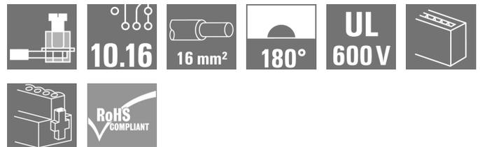
180°-Buchsenstecker im Raster 10.16 für IT-Netze. Erfüllt die Forderungen der UL1059 600 V Class C. In Verbindung mit der Stiftleiste SU 10.16 IT mit voreilem Kontakt.
