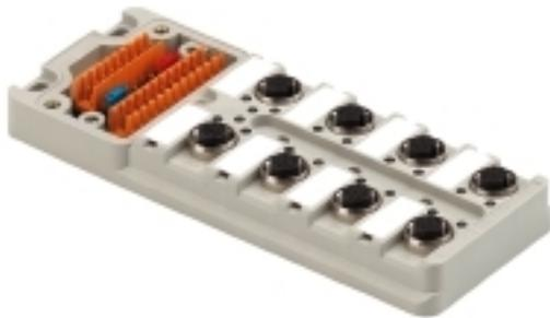
M12 Verteiler werden in allen möglichen Ausführungen angeboten. Die 4,6 oder 8 M12 Steckplätze sind 4 oder 5 polig. Der Sammelabgang ist wahlweise ausgeführt als Festkabelvariante, Haubenvariante zum Selbstanschließen oder mit M23. Weiterhin gibt es einige besondere Ausführungen. So gibt es 1 zu 1 Verteiler für die freie Wahl der Anschlüsse oder auch Verteiler, die für die Ex Zone 1 zugelassen sind.
