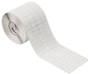
THM GEW Gewebeatiketten werden aus einem sehr flexiblen Baumwollgewebe hergestellt. Die Lieferform auf Rolle für den Einsatz mit Thermotransferdruckern erlaubt eine dickere Kleberschicht als bei A4 Bögen für den Office-Laserdrucker. Beides, die Flexibilität und die dicke Kleberschicht, ergeben höhere Klebkraftwerte und ermöglichen den Einsatz auf winkligen oder runden Objekten, wie z.B. Kabeln oder Schläuchen.
