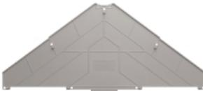
Eine Trennwand wird zur optischen Trennung von Stromkreisen oder zur elektrischen Trennung bei benachbarten Querverbindungen genutzt. Die Kontur kann im Gegensatz zur Abschlussplatte größer als die benachbarten Reihenklammern sein. Kleiner sollte Sie jedoch nicht sein, da ansonsten die geforderten Luft- und Kriechstrecken innerhalb der Applikation nicht mehr eingehalten werden.
