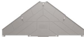
Eine Trennwand wird zur optischen Trennung von Stromkreisen oder zur elektrischen Trennung bei benachbarten Querverbindungen genutzt. Die Kontur kann im Gegensatz zur Abschlussplatte größer als die benachbarten Reihenklammern sein. Kleiner sollte Sie jedoch nicht sein, da ansonsten die geforderten Luft- und Kriechstrecken innerhalb der Applikation nicht mehr eingehalten werden.
