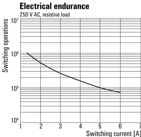
Vida útil eléctrica 230 V AC resistive load
