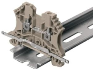
Mit dem LS 2.8 WDU2.5-10 lassen sich viele Durchgangsreihenklammern aus der W-Reihe ganz einfach umrüsten. Das Einlegen des LS 2.8 WDU2.5-10 ermöglicht es das Leitungsschirmgeflecht direkt an der Reihenklammer durch Anlöten oder mittels geeigneter Flachkabelschuh durchzuschleifen.
