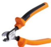
Режущие инструменты для проводников наружным диаметром до 8, 12, 14 и 22 мм. Особая геометрия лезвия обеспечивает резку медных и алюминиевых проводников без пережатия и с минимальным физическим усилием. Режущие инструменты (от КТ 8 до КТ 22) также поставляются с защитной изоляцией до 1000 В, прошедшей испытания VDE и GS, в соответствии со стандартом EN/ IEC 60900.
