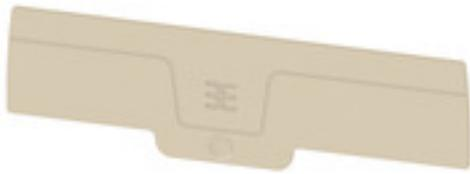
Концевые пластины крепятся к открытой стороне последней клеммы перед концевым стопором. Благодаря использованию концевой пластины обеспечивается работоспособность клеммы и заданное расчетное напряжение. Гарантируется защита от прикосновения к деталям, находящимся под напряжением, и таким образом клеммы безопасны для прикосновения.
