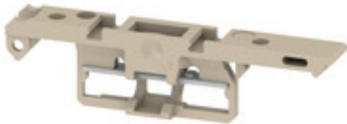
Держатель предохранителя SIHA в мгновение ока превращает клемму с размыкателем в клемму с предохранителем: просто удалите размыкающий рычажок и установите вилку предохранителя.
