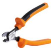
Режущие инструменты для проводников наружным диаметром до 8, 12, 14 и 22 мм. Особая геометрия лезвия обеспечивает резку медных и алюминиевых проводников без пережатия и с минимальным физическим усилием. Режущие инструменты (от КТ 8 до КТ 22) также поставляются с защитной изоляцией до 1000 В, прошедшей испытания VDE и GS, в соответствии со стандартом EN/ IEC 60900.
