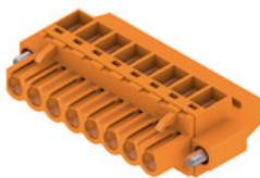
Гнездовые разъемы с соединением с зажимным хомутом для подключения проводов с направлением выводов под прямым углом (90° или 270°). Гнездовые разъемы обеспечивают место для маркировки и допускают кодирование. Крепление осуществляется с помощью фланца или фиксатора. Кроме того, они оснащены встроенным винтом с двумя шлицами (прямым и крестообразным), защитой от неправильной вставки провода и поставляются с открытыми зажимными хомутами. HC = высокоточный.
