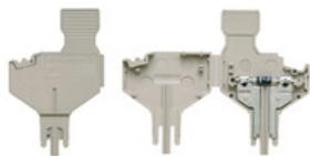
Компонентный штекер служит для интеграции электрического компонента в расплющивающий клеммный блок. После пайки электронного компонента вставку можно интегрировать в расплющивающую зону расплющивающих клеммных блоков, тем самым преобразуя расплющивающий клеммный блок в модульный клеммный блок с интегрированным электронным компонентом.
