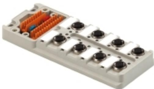
Концентраторы с разъемами M12 предлагаются во всех возможных исполнениях. 4, 6 или 8 разъемов M12 являются 4- или 5- полюсными. По выбору, общий вывод выполняется как вариант с фиксированным кабелем, вариант с кожухом для самостоятельного подсоединения или с M23. Кроме того, имеется несколько специальных исполнений. Так имеются концентраторы 1 - 1 для произвольного выбора подсоединения или также концентраторы, сертифицированные для взрывоопасной зоны Ex 1.
