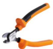
Режущие инструменты для проводников наружным диаметром до 8, 12, 14 и 22 мм. Особая геометрия лезвия обеспечивает резку медных и алюминиевых проводников без пережата и с минимальным физическим усилием. Режущие инструменты (от КТ 8 до КТ 22) также поставляются с защитной изоляцией до 1000 В, прошедшей испытания VDE и GS, в соответствии со стандартом EN/ IEC 60900.
