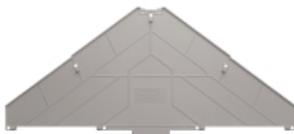
Разделительная пластина используется для оптической изоляции цепей или электрической изоляции от соседних перемычек. В отличие от торцевой пластины контур может быть больше, чем смежные клеммные блоки. Однако он не должен быть меньше, поскольку в противном случае требуемое безопасное расстояние и расстояние утечки не гарантированы в ходе эксплуатации.
