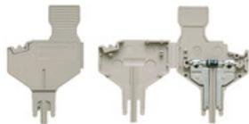
Компонентный штекер служит для интеграции электрического компонента в распепляющий клеммный блок. После пайки электронного компонента вставку можно интегрировать в распепляющую зону распепляющих клеммных блоков, тем самым преобразуя распепляющий клеммный блок в модульный клеммный блок с интегрированным электронным компонентом.
