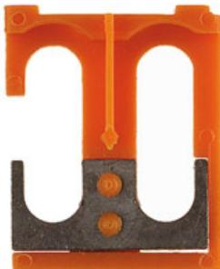
В две клеммные колодки проводной разводки измерительных трансформаторов вставляют замыкающие перемычки. Использование замыкающей перемычки обеспечивает создание нужных цепей короткого замыкания в сценариях, связанных с проведением работ по техническому обслуживанию.
