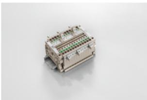
マーカーホルダーは、5 または 5.1 mm ピッチの標準マーカーを追加で取り付けることができます。斜め型ホルダーはオプションで一緒にスナップ可能で、Klippon<sup>®</sup> コネクタモジュール端子台のすべての標準マーキングチャンネルに設置できます。対応マーカーの種別は、指定印字ホルダーの各アクセサリの下で確認できます。
