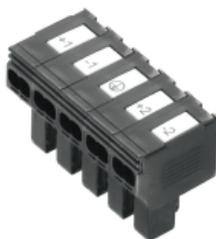
断面積 1.5 ~ 6 mm の未切断ケーブル使用の分配器。電源 / T 分岐タップは、プッシュイン接続 (0.5 ~ 10 mm) またはプラグイン接続 (0.5 ~ 4 mm) を介して接続します。色分けマーキングは、配線割り当てを明確にします。
