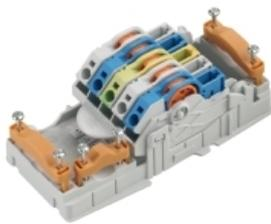
断面積 1.5 ~ 6 mm の未切断ケーブル使用の分配器。電源 / T 分岐タップは、プッシュイン接続 (0.5 ~ 10 mm) またはプラグイン接続 (0.5 ~ 4 mm) を介して接続します。色分けマーキングは、配線割り当てを明確にします。
