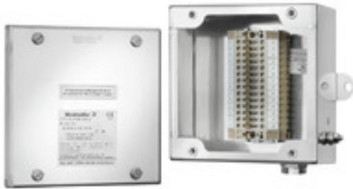
爆発危険区域に信号 / 電源または分電器を設置する際に、さまざまな種別の端子ボックスを使用できます。端子ボックスは、ゾーン 0、1、2、20、21、22 の防爆区域での使用が承認された爆発保護機器です。それらは、最新の国際規格 Ex e、Ex ia、Ex tb に準拠した認可を取得しています。お客様固有の設定では、これらの端子ボックスがすべてのアプリケーションに最適なソリューションとなります。製品の概要を参照して、お客様に最適なソリューションを見つけてください。スレッド穿孔の有無に関係なく、最適な取り付けレールまたは適合済のストリップ端子をエンクロージャーに組み合わせます。お客様に合わせて少し選択を行いました。お客様に最適な調整ソリューションを構成できます。
