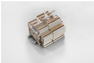
SnapMark - このタグキャリアは、Iモデルシリーズの二段端子 IDK 1.5N に対応して特別に開発されています。柔軟なピボット機構は、渡り配線の容易な取り付け、取り外しを可能にします。4種の DEK 5 ラベリングタグ、または2種の WS 10/5 Middle コネクタマーカを保持できます。
