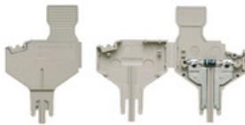
コンポーネントプラグは、電子コンポーネントを接続断端端子台に統合するために使用されます。電子コンポーネントのはんだ付け後、プラグを接続断端端子台の断路箇所を組み込むことで、断路端子台を電子コンポーネント内蔵型のモジュラー端子台に変更します。
