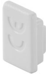
エンドキャップとカバーは、バスバーの切断長さや、独立接触の場合でも、システム内で必要な沿面距離を確保し、DIN EN 50274 に従ってフィンガーセーフを保証します。
