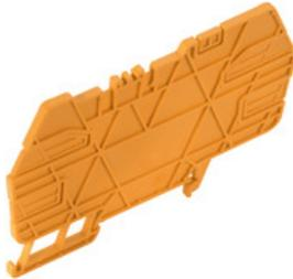
汎用性の高い分離プレートより良好な全体状況のために、分離プレートは、視覚的に信号をまとめたり、モジュールを電氣的に絶縁したり、マーキングを挿入するように使用されます。これにより、それらは特に汎用性の高いアクセサリとなります。分離プレートにより、2つのモジュール間の空気パスおよびクリーブパスが増加し、2つのモジュール間の定格絶縁電圧が最大600 Vに増加します。二重分離プレートには WAD5 または WS10/5 マーカーを表示し、継続的な渡り配線を可能にします。渡り配線チャンネルを個別に分割するための通気孔により、設置が容易になります。
