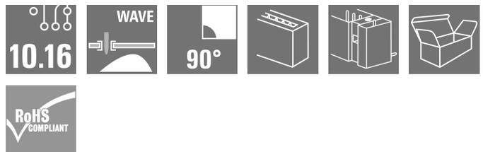
単列、高電流オス型ヘッダーは電極を犠牲にすることなく整列状態に取り付けることができます。また、ツール不使用ですばやくロックするための特許取得済みのフランジが付属します。接合プロファイルにより、固有に識別可能なコーディング多様性およびフランジへの追加締め付けにより、誤接を防止し、接続性と動作信頼性が最大限に向上します。3.5mm 長のピンは、フローはんだ付けに対して最適化され、プラグイン方向は、はんだ付けピンに対して 90° です。
