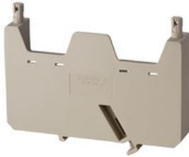
サポートブラケットは、端子レール内の 10 x 3 バスバーを固定します。ワイドミュラーは、メンテナンス作業中に必要なバスバー位置の安定性を確保するため、少なくとも 20 cm 毎のリテーニングプレート設置を推奨しています。さらに、サポートブラケットは、回路の光分離に使用されるか、または隣接する渡り配線コネクタから電氣的絶縁するために使用されます。エンドプレートとは対照的に、輪郭は隣接する端子台よりも大きくなる場合があります。ただし、アプリケーション内で必要な空気パスおよびクリープパスを維持できなくなるため、この値は小さくしないでください。
