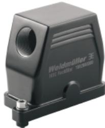
新型 RockStar® エンクロージャーは、海水に対する耐久性を有し、IP 68 および IP 69K に適合し、過酷な環境下での使用を想定して開発され、DIN EN 61373 cat に準拠した高い振動要件に対応するように設計されています。2 (ボギー)。このため、このハウジングシリーズは、トランスポートないしトラフィックエンジニアリング、電力工学、および非常に厳しい要件のアプリケーションでの、ヘビーデューティコネクタの障害やメンテナンスを伴わない操作に最適です。開発中に、エンクロージャーを EMC に対して非常に抵抗性の高いものにする対策も実施されました。
