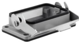
特殊鋳造合金と多層表面シーリングにより、HDC ハウジングを完全に保護することができます。巧みに設計されたインターロックシステムは、ステンレス鋼で製造されています。これは、腐食および衝撃に対して高い耐久性を有し、長寿命を保証します。ハウジングインターロックシステムは、統合安全を提供します。当社独自の特許取得済スプリングシステムは、ハウジングの連動を安全なグリップで提供し、誤って開くのを防ぎます。レーザーマーキングにより、簡単かつ迅速に識別できます。各ハウジングには、各製品を素早く指定して位置決めできるように、レーザーマーキングで恒久的なラベルが付けられています。ワイドミュラーの RockStar® IP 65 / NEMA 種別 4X のハウジング - IP 65 保護を備えた工業用ハウジングの第一の選択肢。
