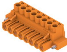
配線を直線 (180°) の接続方向に接続対応の、クランプヨークねじシステム搭載メス型プラグ。メス型コネクタは、マーキングスペースがあり、識別表示が可能です。フランジまたはリリースラッチで固定します。また、プラス/マイナスネジが組込まれたクランプヨークは、電線の誤挿入防止機能を有し、クランプは開いた状態で納入されます。HC = 高電流。
