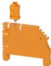
差し込み式端子台の固定ブラケットは、各プラグのメカニカルファスナとして機能します。それらはコネクタと接点の両方を機械的応力から保護し、振動による予期せぬ緩みから保護します。
