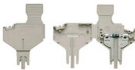
コンポーネントプラグは、電子コンポーネントを接続断端端子台に統合するために使用されます。電子コンポーネントのはんだ付け後、プラグを接続断端端子台の断端箇所を組み込むことで、断端端子台を電子コンポーネント内蔵型のモジュラー端子台に変更します。
