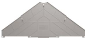
仕切板は、回路の光分離に使用されるか、または隣接する渡り配線コネクタからの電氣的絶縁に使用されます。エンドプレートとは対照的に、輪郭は隣接する端子台よりも大きくなる場合があります。ただし、アプリケーション内で必要な空気パスおよびクリープパスを維持できなくなるため、この値は小さくしないでください。
