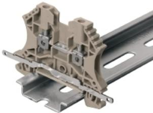
LS 2.8 WDU2.5-10によって、W シリーズの多数のフィードスルーモジュラー式端子台を非常に簡単に変換できます。LS 2.8 WDU2.5-10を挿入すると、ケーブルシールドブレードは、はんだ加工または適切なフラットケーブルラグを使用して、端子台で直接ループできます。
