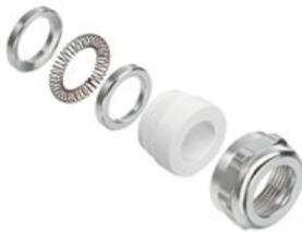
電子部品の感度の向上と電磁干渉周波数の増加により、ケーブルグランドはシステムの外装コンセプトにおいて重要な役割を果たす必要があります。この種別の EMC ケーブルグランドは、360 のスクリーニング接続で、干渉周波数に対する遮蔽を目的に作成されています。フィンガーロックシールは、優れたケーブル保持とケーブル負荷解放部品を提供し、ケーブルグランドは EN 62444 の機械的要件に準拠します。特許取得済形状により、非常に簡単に高速な組み立てが可能になります。
