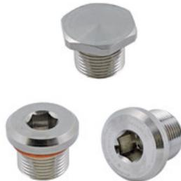
Les bouchons d'obturation de la série VP constituent une méthode pour remplir les entrées inutilisées dans les équipements Ex, tout en maintenant une protection antidéflagrante Ex d, une protection contre les explosions Ex e à sécurité accrue et un indice de protection IP66/67/68.
