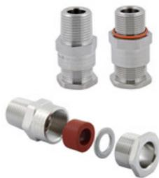
Les presse-étoupes de type A2L conviennent pour les câbles non armés. Ils maintiennent une protection antidéflagrante Ex d et une protection contre les explosions Ex e à sécurité accrue.
